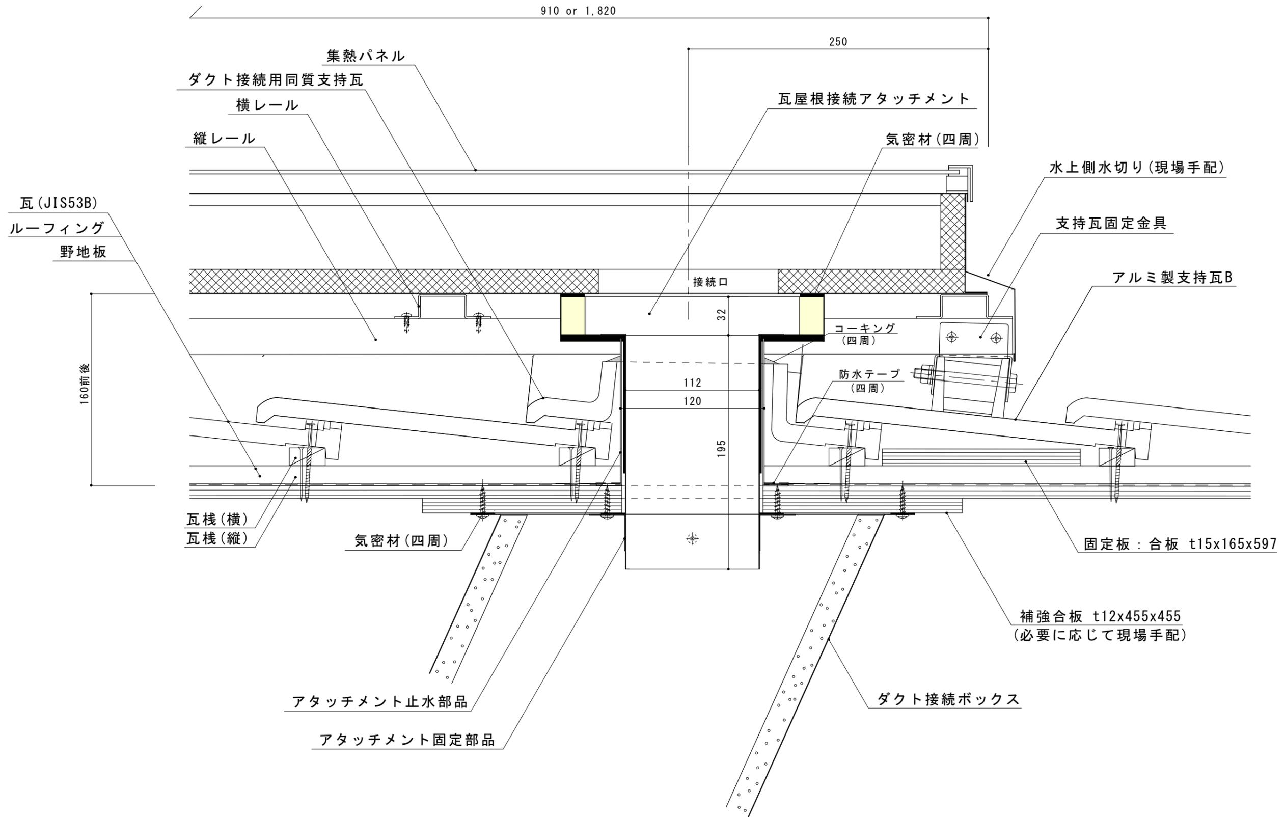
和瓦 (JIS53B) の上に縦型集熱パネル4Pを設置する場合の架台割付例
