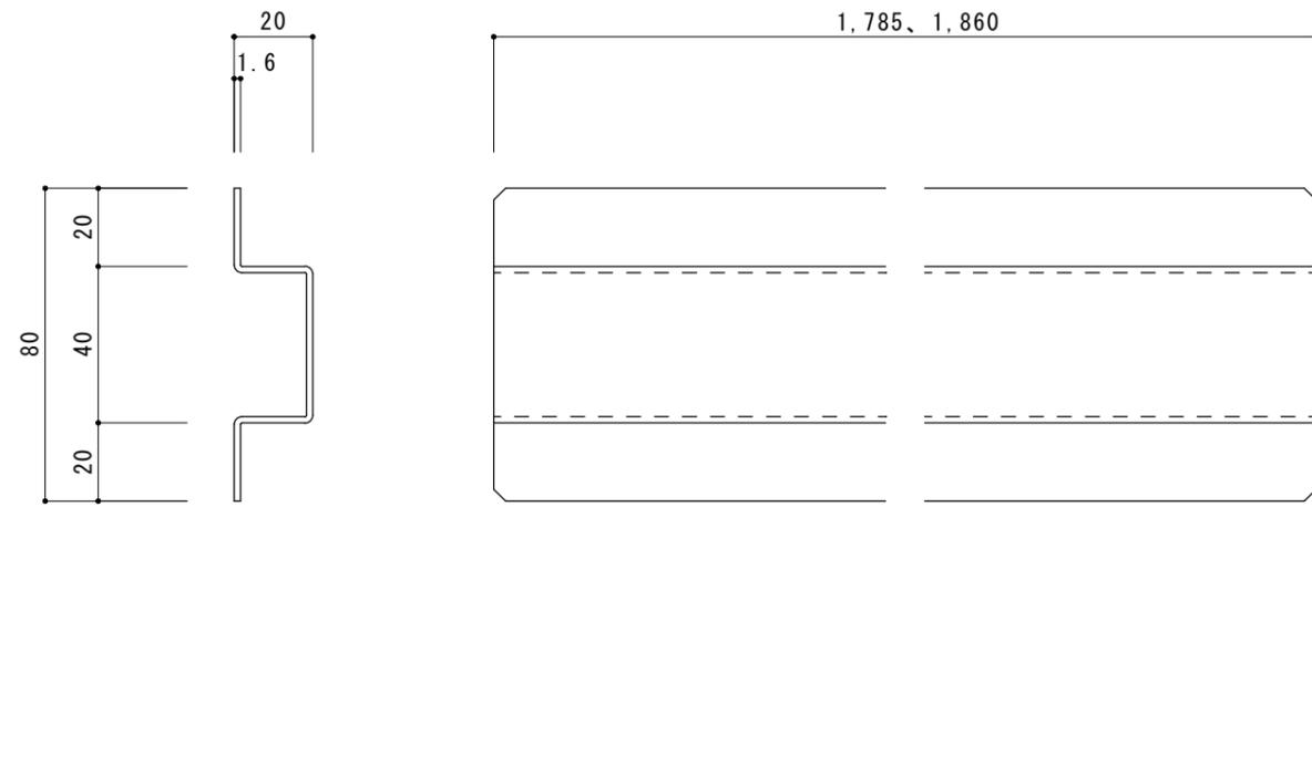
縦型集熱パネル4P架台 部材リスト
