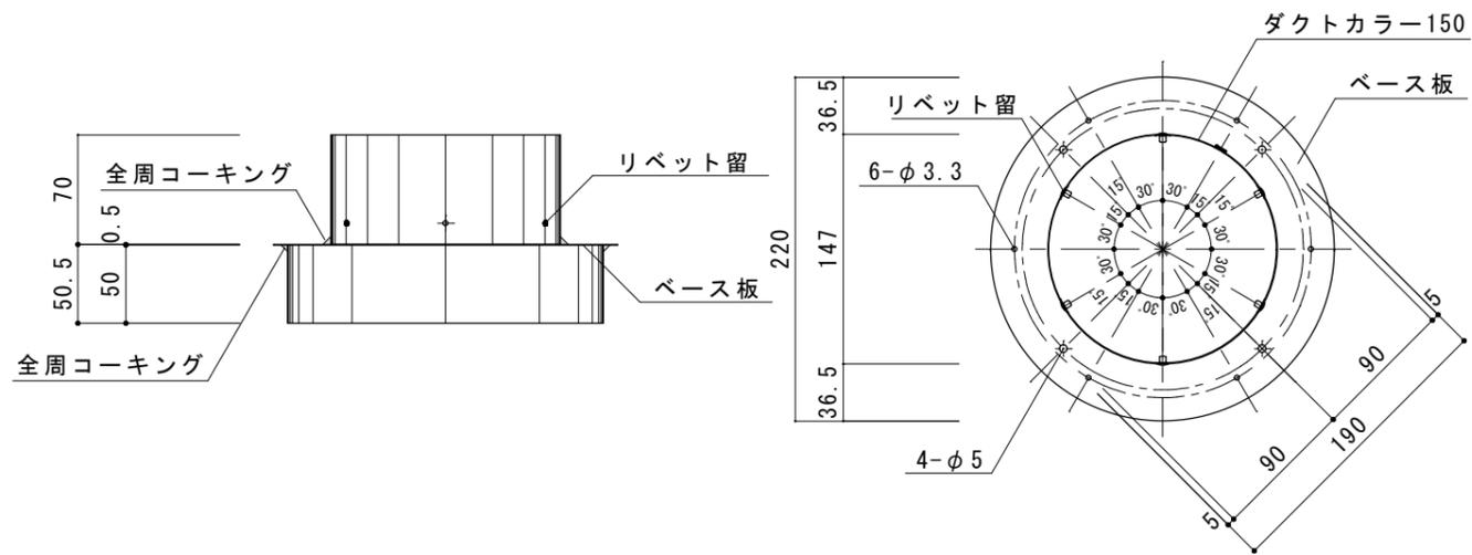
使用例①：GWダクトと断熱フレキシブルダクトの接続
