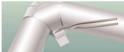
② 片側折り返し部のかみ合わせ巾を見て切り捨て 反対側を倍の中で切り捨てる。
