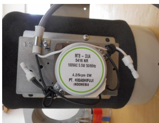
モーターカバーを外したところ
