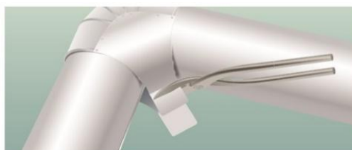
② 片側折り返し部のかみ合わせ巾を見て切り捨て 反対側を倍の巾で切り捨てる。
